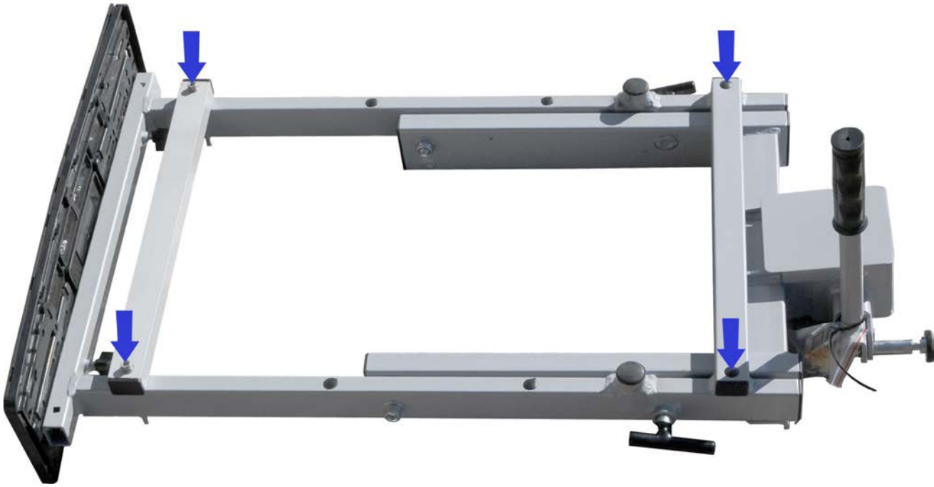
Bild 1: An den gekennzeichneten Positionen wird die Box mit dem Träger verschraubt.
