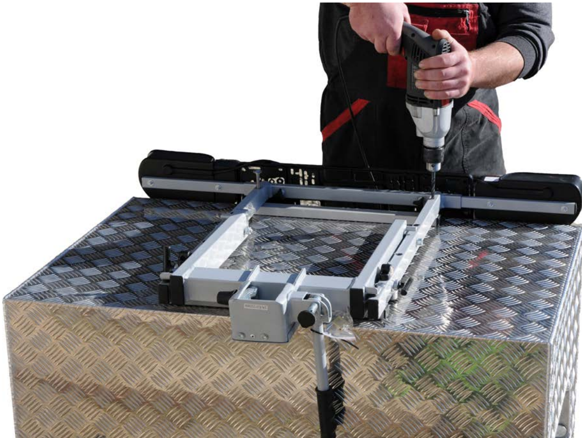
Bild 2: Positionierung des Trägers auf der Kiste, dient gleichzeitig als Bohrschablone. Nach dem Bohren der Löcher die Box mit dem Träger verschrauben.
